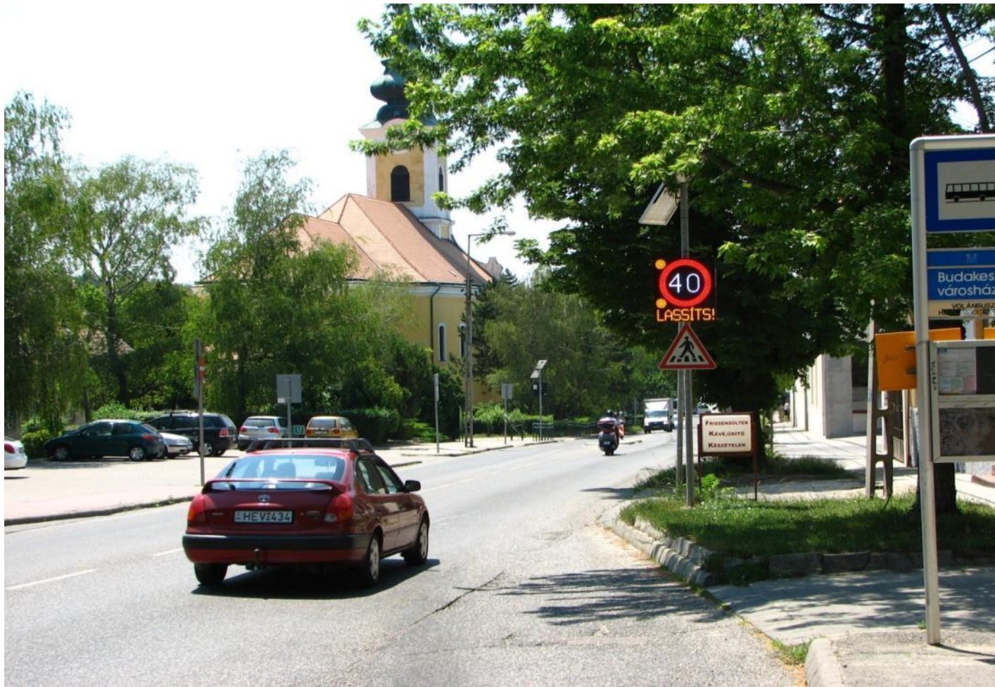
Budakeszi, 8102. j. út, sebességkorlátozásra figyelmeztető berendezés
